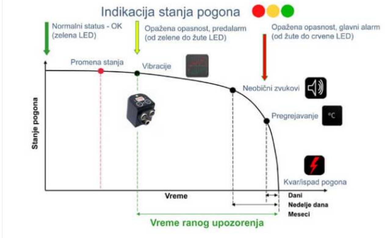
Slika 3.: Grafički prikaz statusa uređaja i ranog otkrivanja potencijalnog kvara uređaja na osnovu alarma
